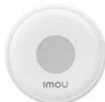
Quando si verifica un'emergenza, premere l'interruttore wireless per chiamare i soccorsi attraverso il gateway. Il gateway emette un allarme locale e invia il messaggio all'APP dell'utente. Il pulsante può essere utilizzato come interruttore intelligente per realizzare il collegamento tra dispositivi di collegamento
